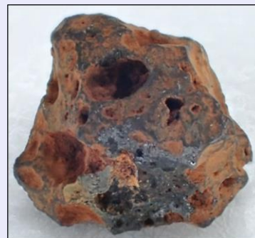
＜燃料デブリサンプル外観＞ （約5mm×約4mm）
