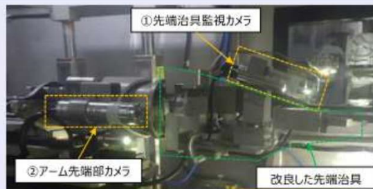
交換したカメラ①②・改良した先端治具
