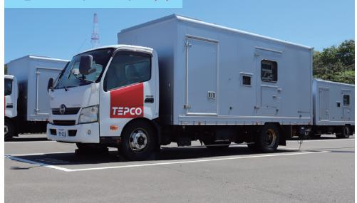
プラントの交流電源が失われた際に、重要機器へ電源を供給します。機動性に優れ、必要なときに必要な場所へ移動して電気を供給できます。
