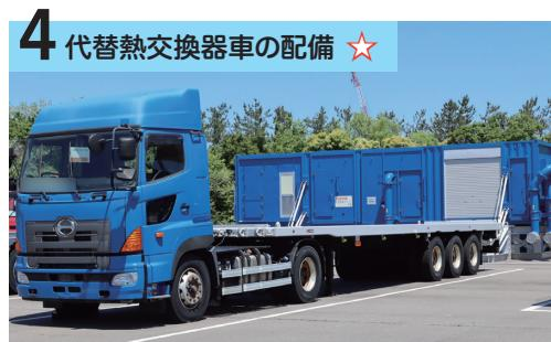
既存の除熱設備が使えなくなった場合に、原子炉や原子炉格納容器内を冷やす設備です。これを用いることで、少なくとも約10日間は大気への放射性物質の放出を遅らせることができます。
