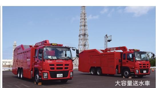
原子炉や使用済燃料プール内から放射性物質が放出される恐れがある場合、放水砲と大容量送水車を接続し原子炉建屋の開口部に放水します。大容量送水車は、最大で毎分2万リットル送水でき、タンクローリーからの燃料補給で連続運転が可能です。タンクローリーからの燃料補給が受けられない場合は、送水車に付属している燃料タンクを用いることで約12時間放水を継続できます。
