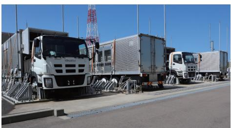
軽油の燃焼ガスでタービンを回して電気を作る発電機を搭載した車両。送電線からの電気や非常用ディーゼル発電機が使用できない場合の代替電源として、7号機横や海拔21mの高台に分散して配置しています。
