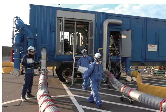
緊急時にも正確かつ速やかに動かせるようにするために、ホイールローダによるガレキ撤去（左）や代替熱交換器車の接続（右）など、可搬型設備の操作・接続訓練を日々行っています。
