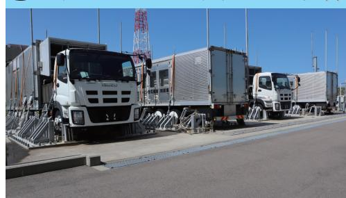
軽油の燃焼ガスでタービンを回して電気を作る発電機を搭載しています。発電所構内の津波の影響を受けない場所に配置しています。
