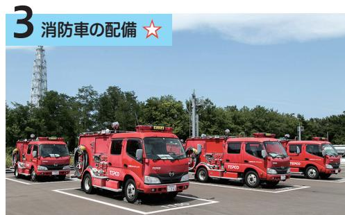
原子炉建屋に接続し、原子炉や使用済燃料プールに注水を行います。同時に使用不能とならないよう、分散配置しています。
