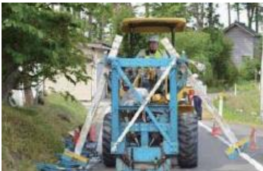
起震車による地下構造の調査
