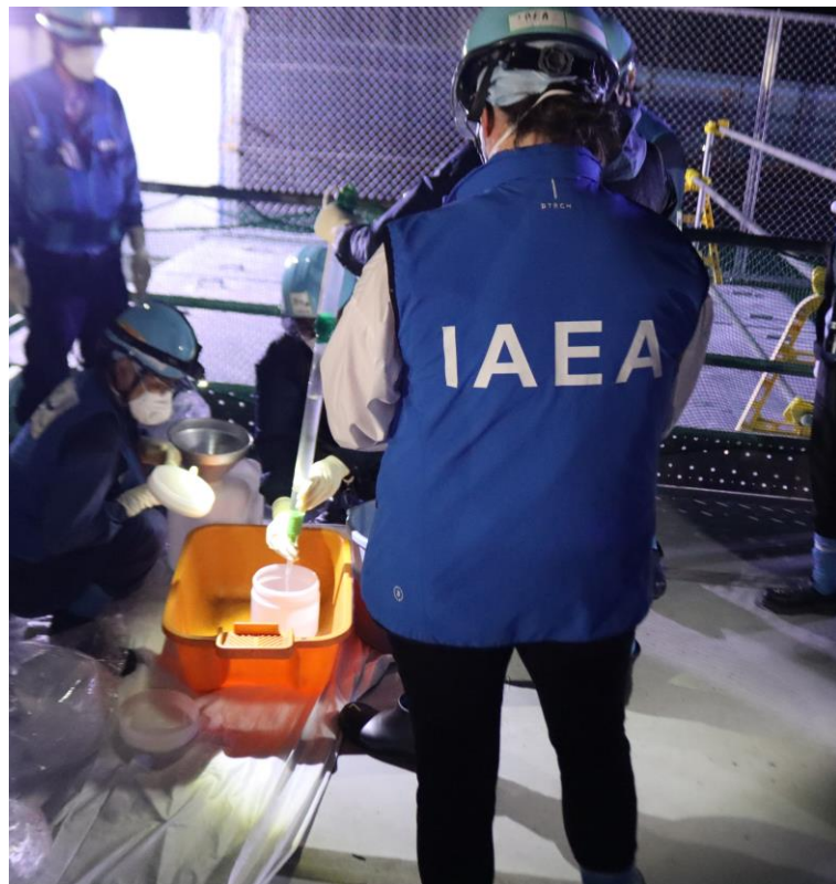
国際原子力機関（IAEA）職員によるALPS処理水の初期の放出（第1段階）における初回採取への立会い <8/22上流水槽からの初回採取への立会いの様子>
