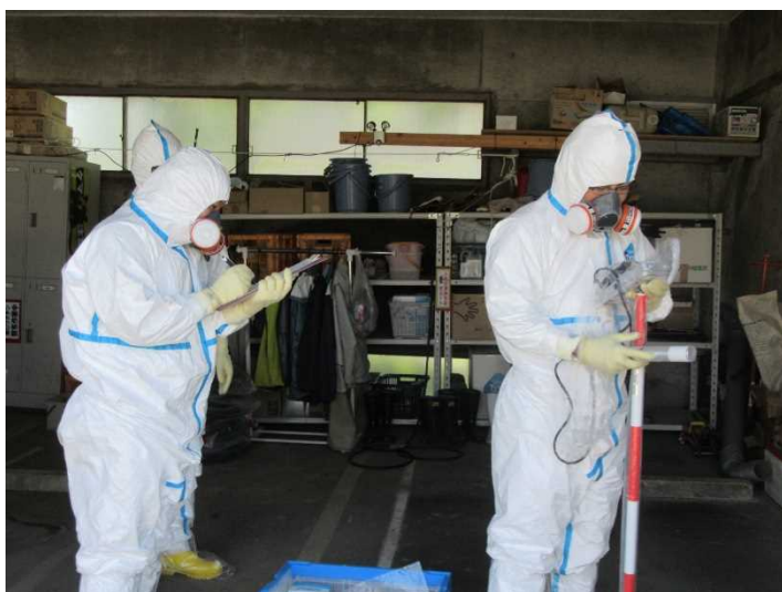
サーベイメータによる空間放射線の測定
