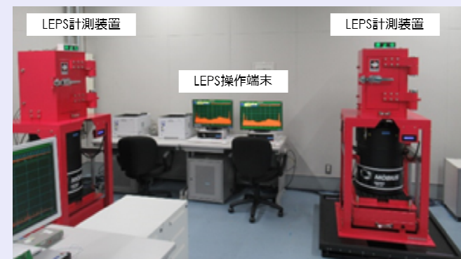
<低エネルギー光子用ゲルマニウム半導体検出器(LEPS)の設置状況>
