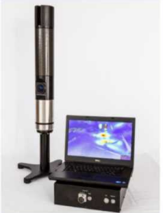
<測定装置(γイメージャ※)> ※γ線測定結果と3Dスキャン情報を組み合わせ、γ線の3次元分布を取得
