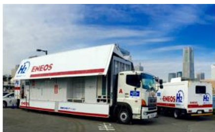
<移動式水素ステーション>
