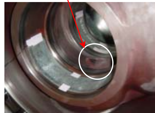
原子炉給水ポンプ欠損の状況
