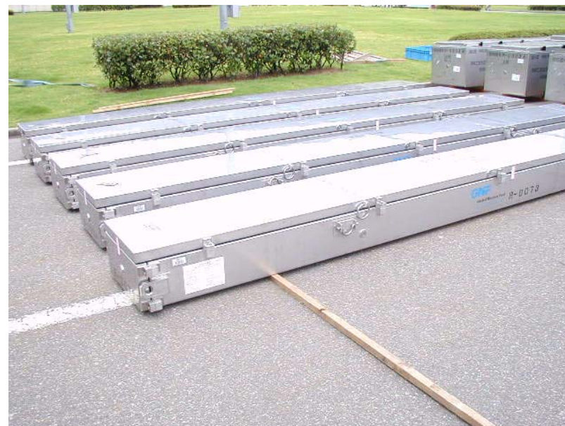
新燃料輸送容器（内側容器） （1箱に2体の新燃料が収納される）
