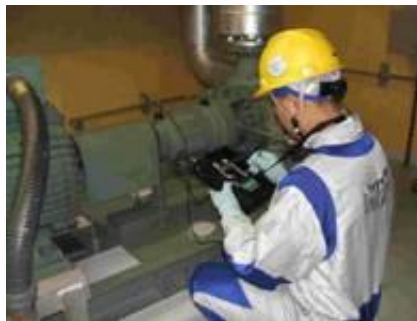
新制度で行う機器の振動測定
