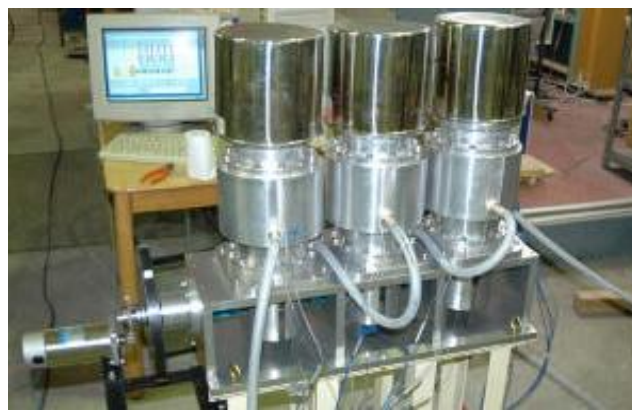
排熱を利用した実験中の発電設備の一部
