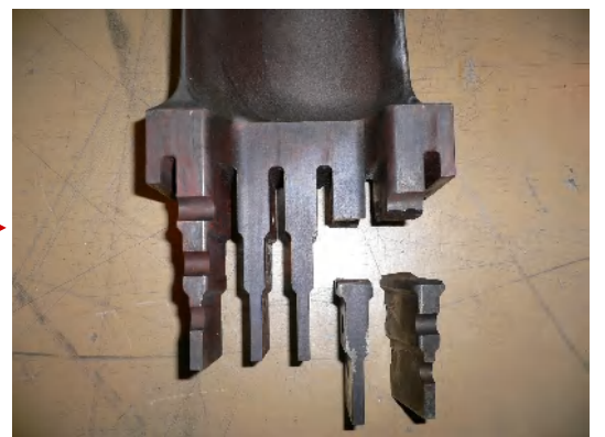
フォーク損傷部(119枚目)
