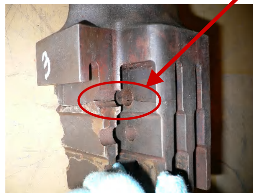
フォーク損傷部(119枚目)
