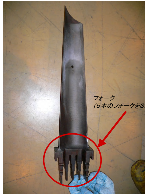
第14段タービン側動翼152枚(1車室あたり304枚)
