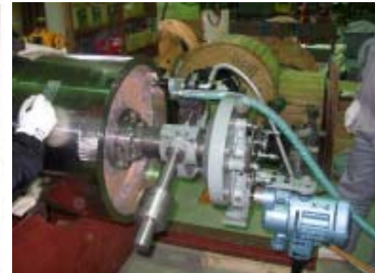
硬化層除去の 模擬試験
