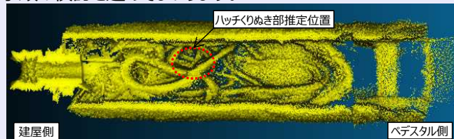
<3DスキャンによるX-6ペネ上方からの堆積物の状況>
