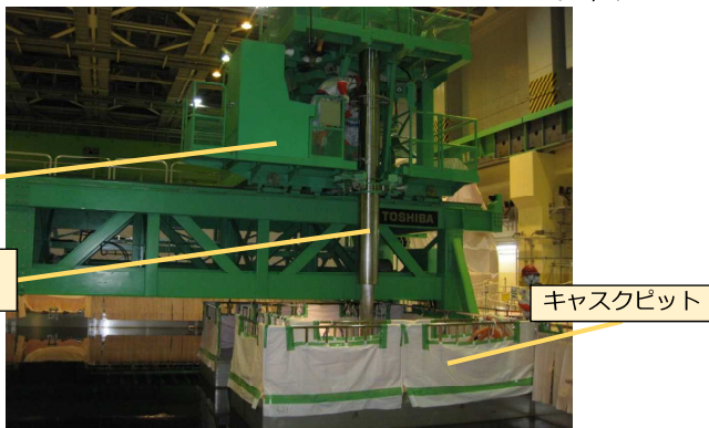
④燃料装填 <6号機使用済燃料プールでの装填作業の様子(7/7,7/8)>
