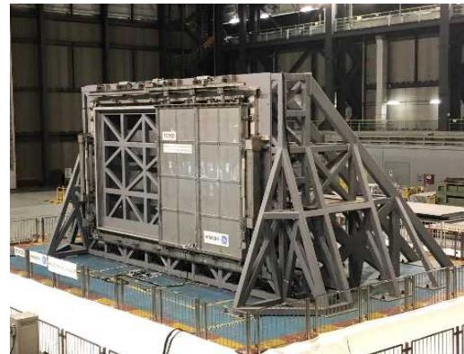
オペロBOP閉止装置加振試験状況
