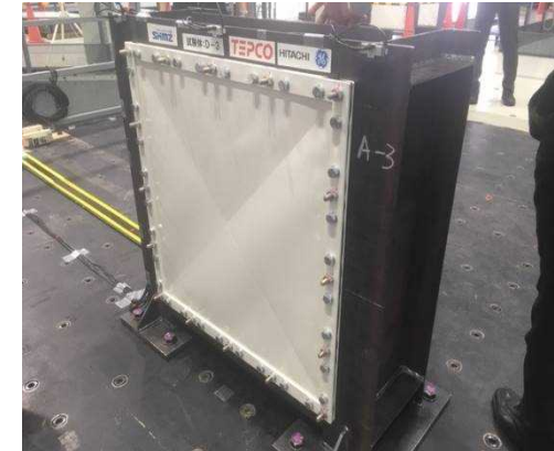
MSTンネル室BOP加振試験状況
