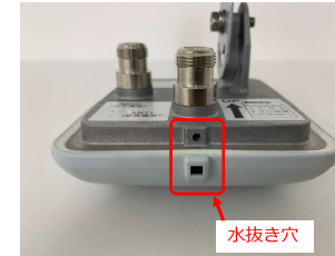
【写真：アンテナ水抜き穴】
