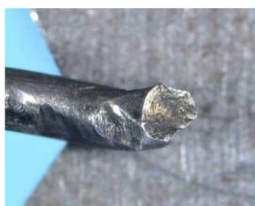
レーシングワイヤ破断面外観
