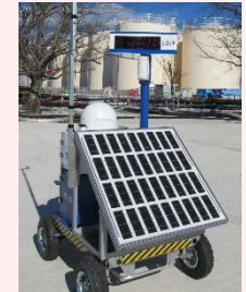
線量率モニタの設置状況
