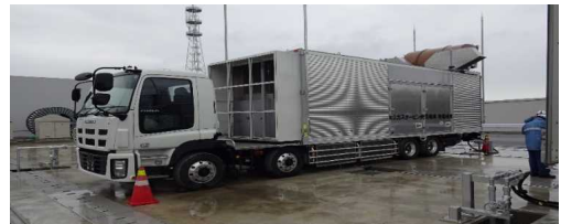
軽油の燃焼ガスでタービンを回して発電
