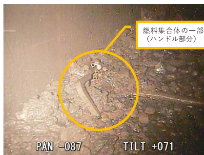
2号機原子炉格納容器内部調査において確認した堆積物と燃料集合体の一部 (1月19日)
