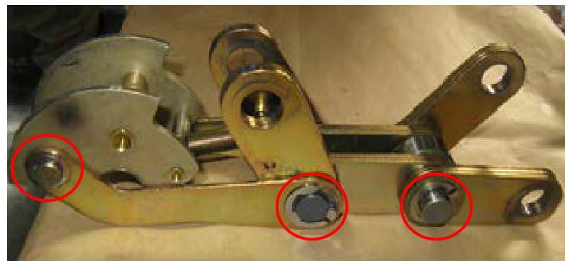
○:潤滑剤の劣化による硬化箇所(主な部位)
