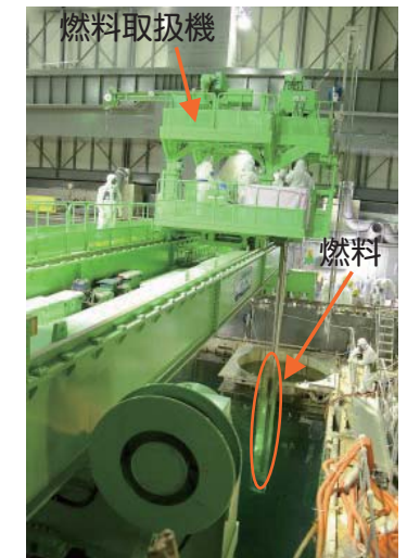
燃料の取り出し
