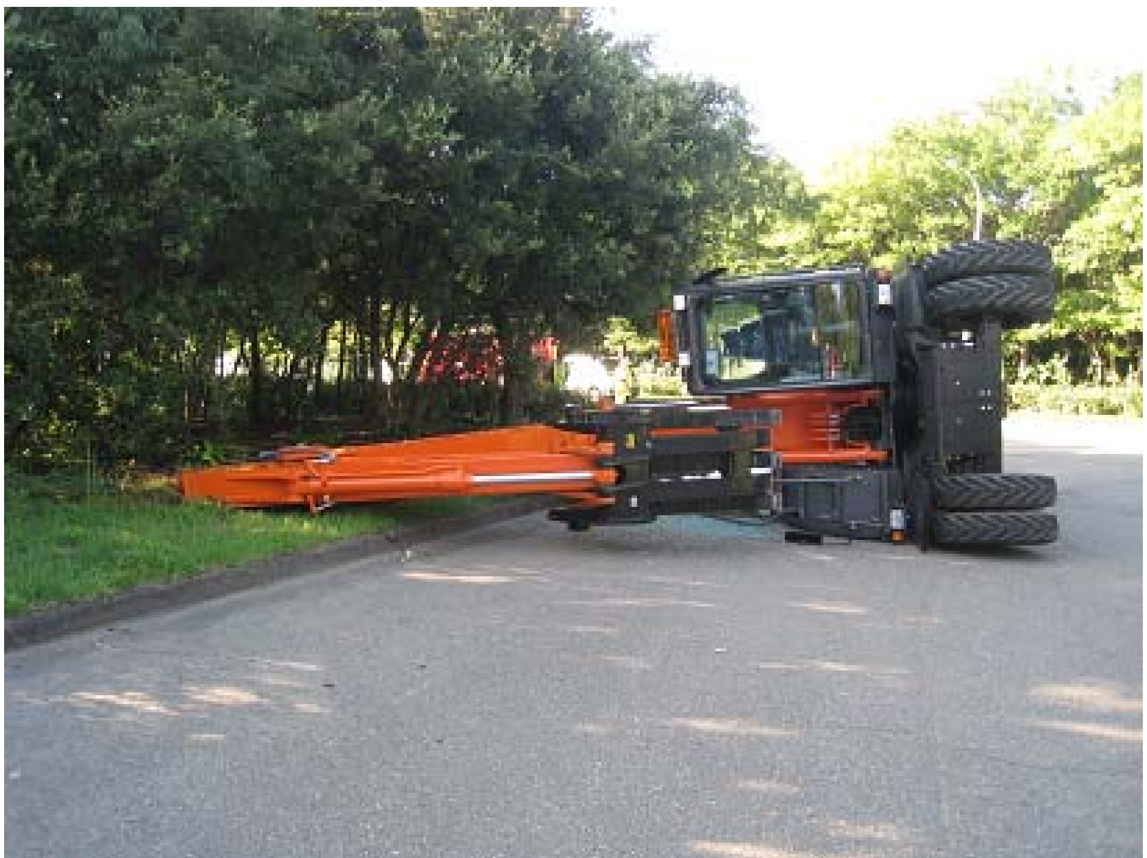
がれき撤去用重機の横転状況
